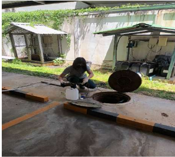
รูปที่ 3.2 การเก็บตัวอย่างคุณภาพน้ำทิ้ง บริเวณ น้ำหลังผ่านระบบบำบัดน้ำเสีย
