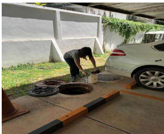
รูปที่ 3.1 การเก็บตัวอย่างคุณภาพน้ำทิ้ง บริเวณน้ำก่อนเข้าระบบบำบัดน้ำเสีย
