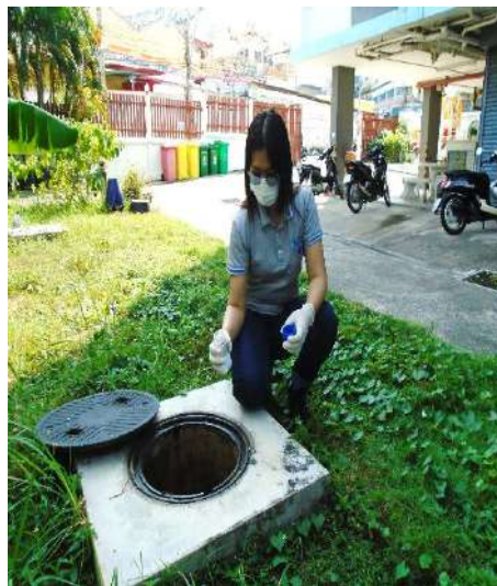
รูปที่ 3.4 การเก็บตัวอย่างคุณภาพน้ำ บริเวณ น้ำในถังเก็บน้ำใต้ดิน
